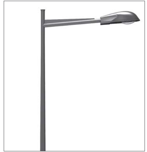
Luminaire LYXEO fixation latérale Ø 60 mm Console C-861 S=1000 mm - incl. 5° Mât Cylindro-conique Ø 60 mm en top
